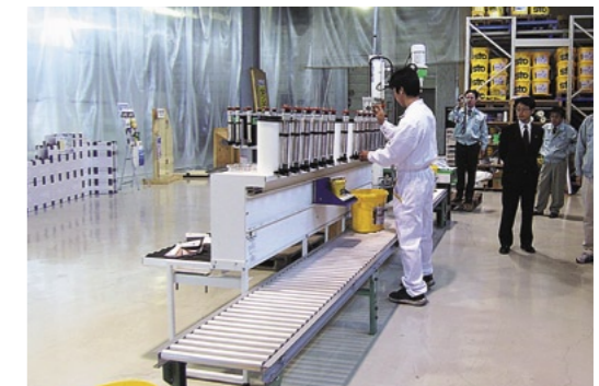
シュトーマーモ・クラシックのトップコートの調色を行うティンティングステーション
