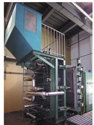
100 cm × 200 cm × 50 cmのEPS断熱材を1時間に10本作ることができる成型機
