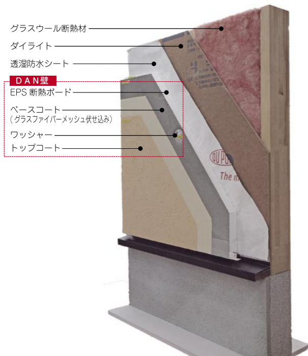
『DAN壁』を施工した外壁のカットサンプル
