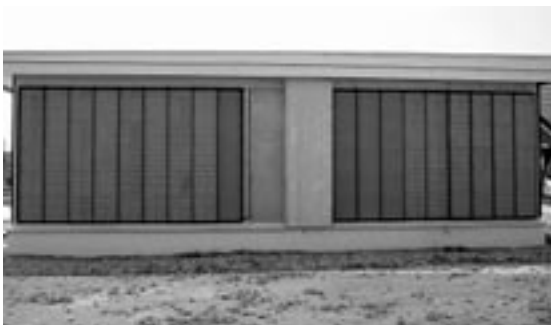
実験棟の北側外観。左右の木造部分は14体の試験体を設置することができ、様々な壁体構成の試験を行うことが可能になっている
